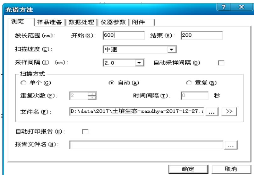
在此对话框中可选择波长测定的范围、扫描的速度、采样间隔、扫描方式等条件。一般仅修改波长测定范围，其他参数按默认的来。在文件名中，按**课题组-姓名-年月日**形式将您的文件保存在 D 盘相对应年份文件夹中。
