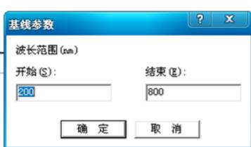
的基线参数图示，点击图示中的确定，仪器对 200 到 800nm 的波长范围进行基线校正，校正结束后返回开始波长，仪器进入待测状态。**注意：基线校正最好是等开机预热 1h，仪器稳定后再进行。**
