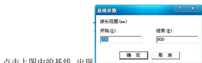
点击上图中的基线，出现
